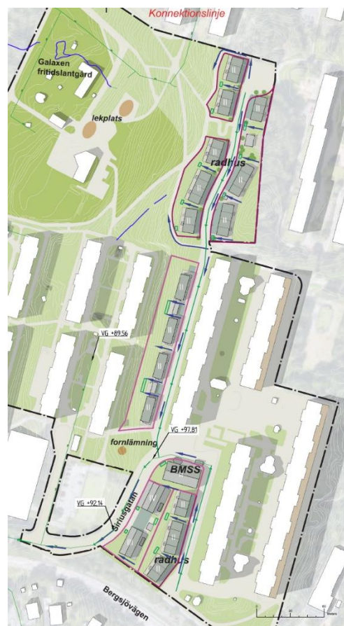
Figur 1: Föreslagen dagvatten- och skyfallshantering inom del av planområdet. Tjocka gröna linjer symboliserar nya dagvattenledningar och gröna rektanglar biofilter/växtbäddar. Blå pilar redovisar rekommenderad höjdsättning för hantering av skyfall.
